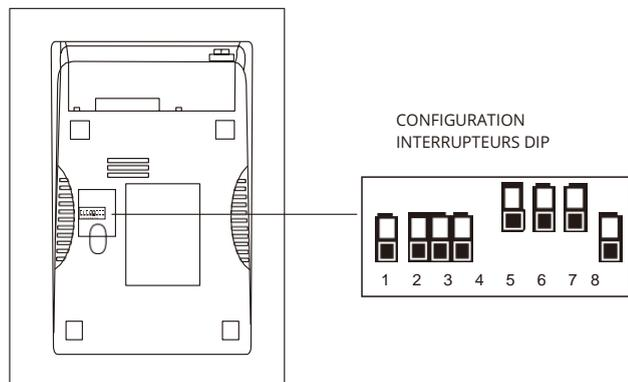
Les interrupteurs DIP modifient les paramètres, tels que : le massicot, la langue, le signal sonore, la densité d'impression, etc.
